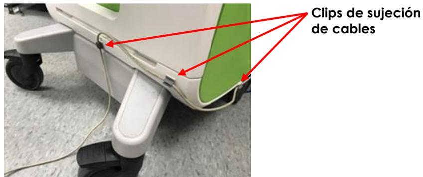
Figura 4. Sujeción del cable del pedal
