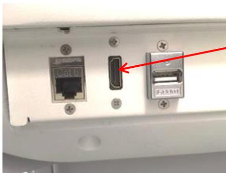
Figura 11. Conector (HDMI) de salida del segundo monitor
