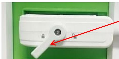
Figura 21. Orientación del conector del transductor
