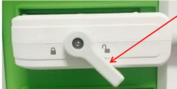
Palanca de bloqueo del conector del transductor (en la posición de desbloqueo)
