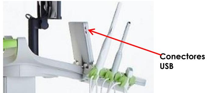
Figura 7. Conectores USB del lado izquierdo de la pantalla táctil
